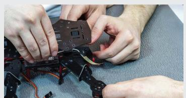
**5** Ponovno spojite ESC-e s motorima. Centrirajte krakove s motorima na donji dio tijela te na njih centrirajte i položite drugi, dizajnom kompatibilni, dio tijela preko distribucijske bakrene pločice (izolirane čvrstom tankom plastikom).
